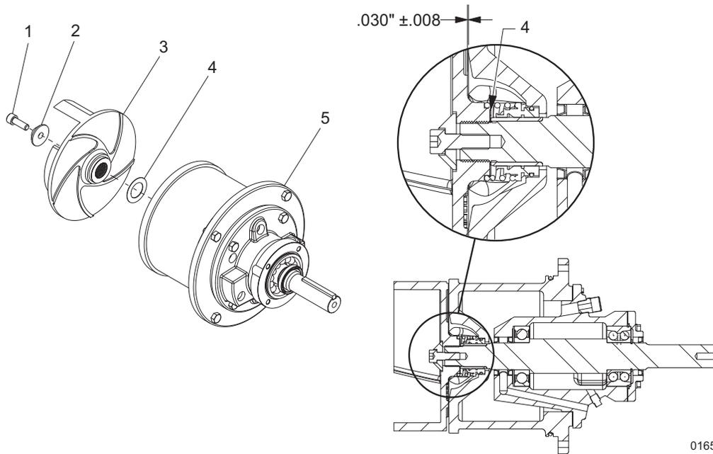
**Figure 4-8. Impeller Components**
